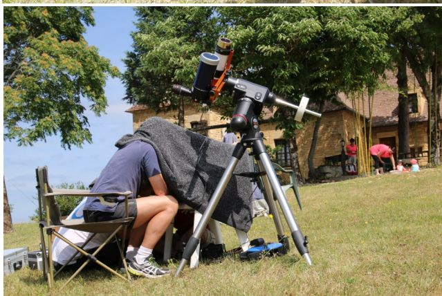
ETX 90 pour la lumière visible en parallèle avec la lunet 60 pour le H alpha.
