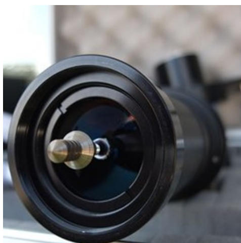
Vue rapprochée sur un des cônes occulteurs, doré à l'or fin par Jean-Paul ROUX.
