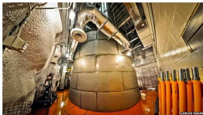
Le détecteur est enfermé dans un gros réservoir rempli d'eau ultra pure, exempte d'éléments radioactifs qui pourraient interférer sur les mesures (contenance : 300.000 litres). Le coeur du détecteur est constitué de 370 kg de xénon liquide, qui génère un flash lumineux lors d'une collision de particule.
