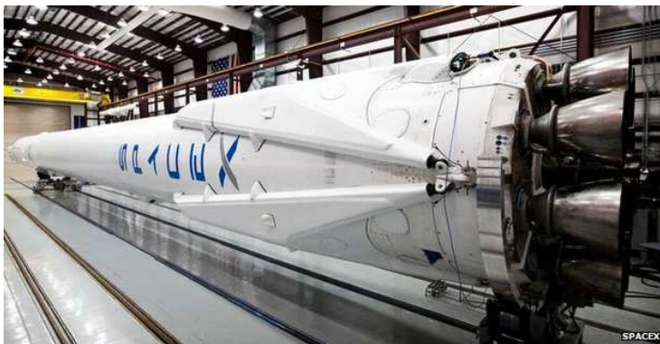
Le dispositif d'atterrissage en douceur (optionnel) placé le long du premier étage de la fusée Falcon-9. Sans cet équipement, l'étage est largué à 80 km d'altitude après 3 minutes de vol et il est détruit en retombant au sol.
