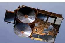
Cryosat et sa configuration à double antenne radar.
