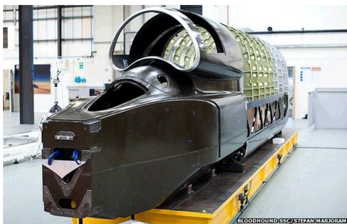
Le châssis de la Bloodhound s'accommode d'un moteur d'avion et d'une fusée.
