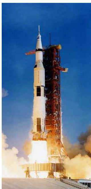
Apollo 11: décollage de la fusée Saturn V. Le 1er étage développait une poussée de 3402 tonnes
