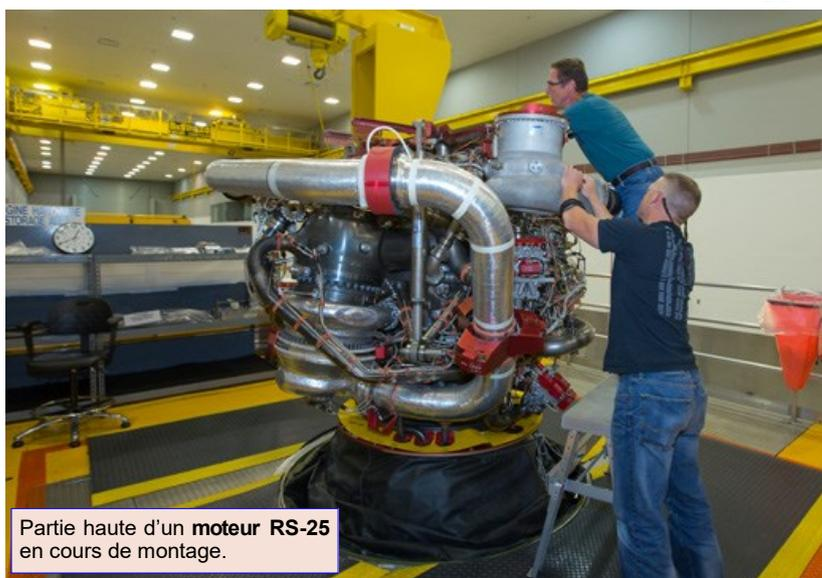
Partie haute d'un **moteur RS-25** en cours de montage.
