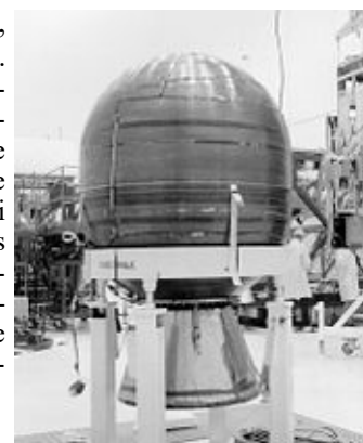
STAR 48 : moteur du 3ème étage pour propulser New Horizons vers Pluton.
