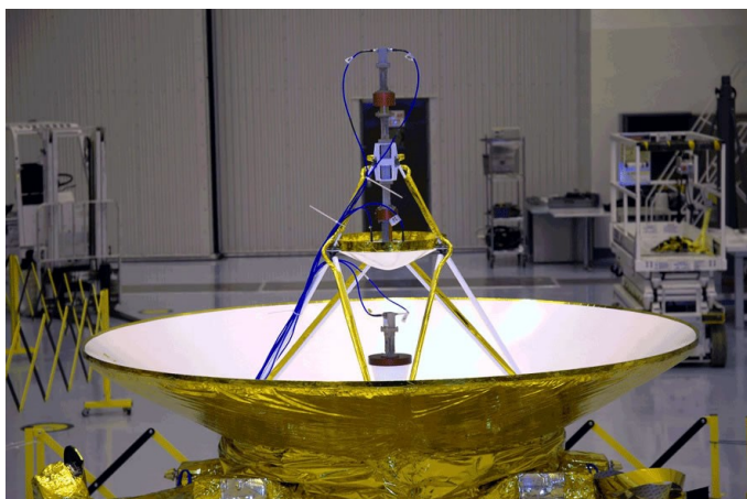
Les antennes de New Horizons en cours de câblage (JHU APL).
