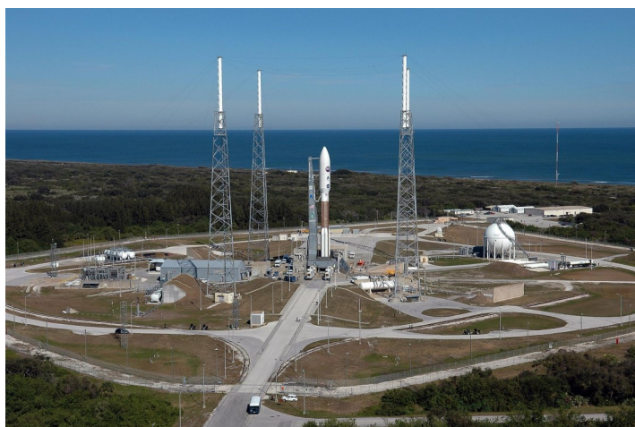
Ci-dessus, la fusée ATLAS V ULA (United Launch Alliance) sur le pas de tir 41 de Cap Canaveral en Floride, prête pour son décollage. A droite, la fusée en cours de préparation en 2005 : 5 boosters AJ-60A, un 1er étage booster, un 2ème étage Centaur, et un 3ème étage Star 48B. NB : ULA est un joint venture Lockheed / Boeing.
