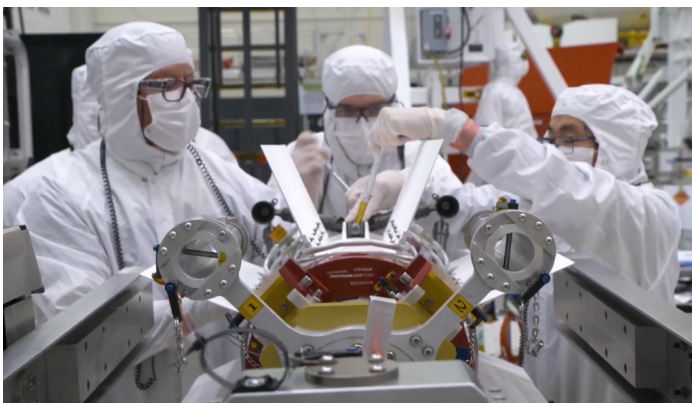
Les ingénieurs travaillent à l'intégration du RTG, dont on voit ici les ailettes de refroidissement (il est situé à l'arrière de Perseverance).
