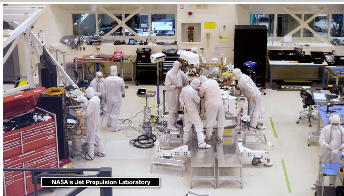
Salle blanche d'assemblage où ingénieurs et techniciens du Jet Propulsion Laboratory de la NASA à Pasadena (Californie) construisent et testent le rover Perseverance avant son expédition sur le site de lancement au Kennedy Space Center, en Floride.
