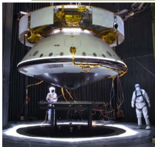
Mars2020 : le vaisseau de croisière avec ses différents ensembles, et ci-dessous, une vue réelle dans une chambre pour un test « chaud et froid ».
