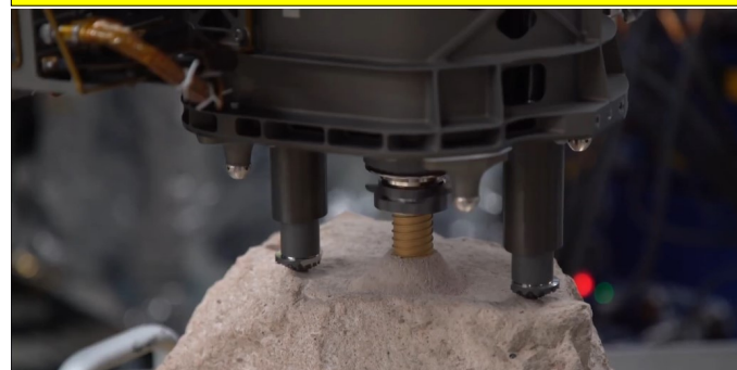
Tête de perçage de Perseverance : un outil robotisé sophistiqué pour prélever des échantillons de roche martienne.
