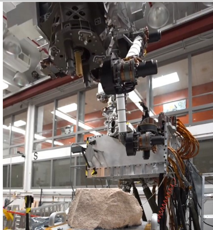
Tête de perçage de Perseverance : un outil robotisé sophistiqué pour prélever des échantillons de roche martienne.
