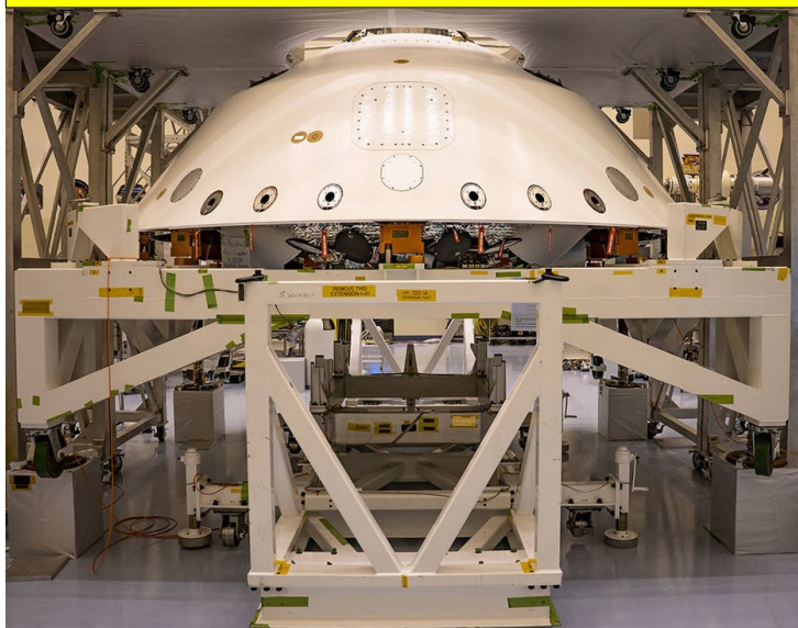
Les ingénieurs au Kennedy Space Center en Floride ont commencé l'intégration des sous-ensembles du vaisseau spatial qui doit s'envoler avec une fusée Atlas V United Launch Alliance dans une fenêtre de tir qui commence le 17 juillet 2020. Le processus d'assemblage « véhicule stacking » a démarré le 23 avril avec la liaison du module de descente avec le rover par 3 boulons spéciaux de séparation pyrotechniques. Ces deux systèmes resteront ensemble jusqu'à 20 mètres au dessus de la surface, puis la grue à fils de nylon (7,6 m) descendra le rover jusqu'au sol ; les fils seront coupés lors du touché au sol du rover par un système de rasoir pyrotechnique, et le module de descente pourra s'envoler plus loin.
