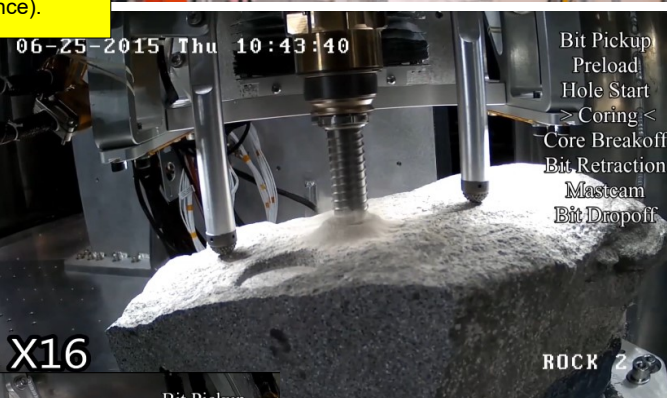
La robotique complexe associée au forage de roches diverses, à l'extraction et au scellement d'échantillons a fait l'objet de nombreux tests.
