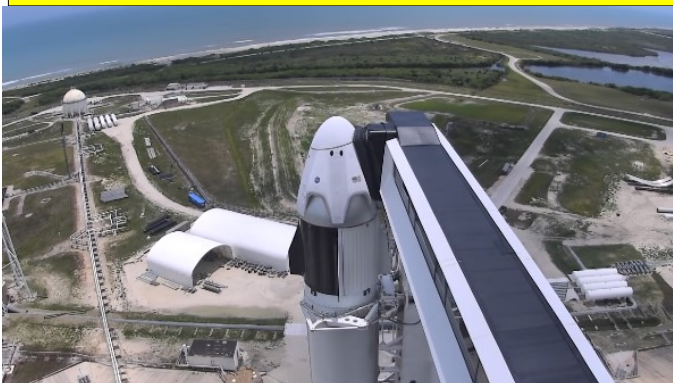
Le bras équipage (crew arm) est un peu l'équivalent de la passerelle d'embarquement des aéroports, avant d'entrer dans un avion.
