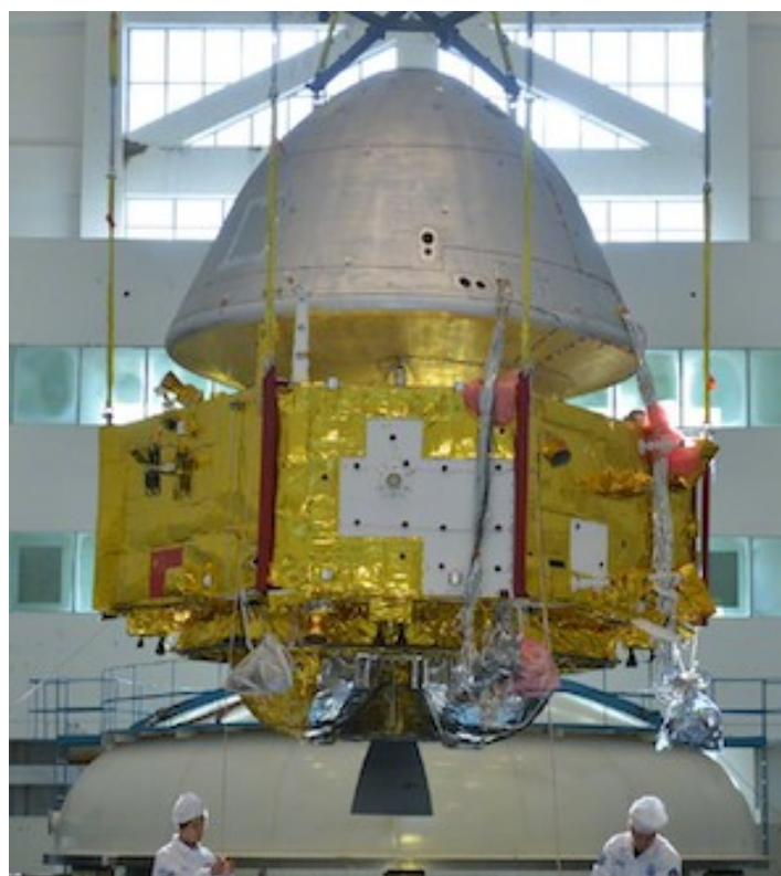
Tianwen-1 en cours d'intégration et de test en 2019. La partie haute contient le rover et son atterrisseur, et la partie basse dorée est l'orbiteur avec son propulseur.
