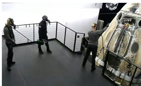
Nettoyage décontaminant avant ouverture. Cette porte d'accès est restée fermée depuis le lancement de novembre 2020.
