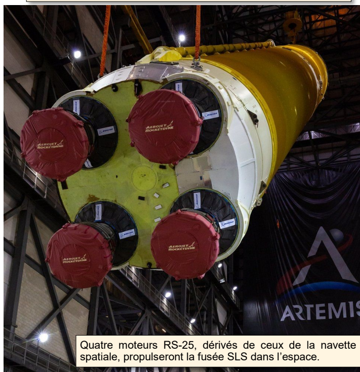
L'étage central est soulevé de sa position dans l'allée de transfert du bâtiment d'assemblage de véhicules (VAB)
