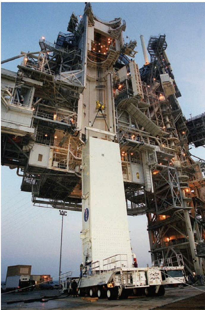
Le transporteur de charge utile peut transporter des charges utiles dans la boîte verticalement ou horizontalement. Sur la rampe de lancement (ci-dessus), la boîte est prête à être soulevée dans la salle de changement de charge utile, sur la structure de service tournante (RSS).
