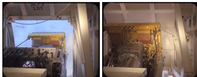
Rétractation et protection du système d'approvisionnement en oxygène liquide (LOX) au réservoir externe
