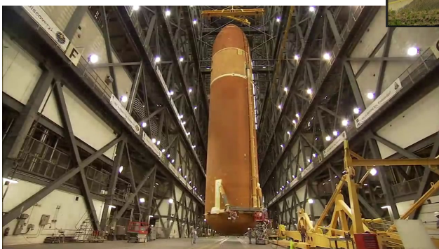
Le réservoir externe de la navette (ET) est mis à la verticale pour être accolé à la navette (bâtiment VAB).
