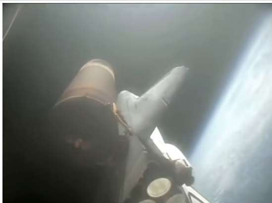
Image prise par la caméra haute du SRB gauche de la navette, juste après son éjection.
