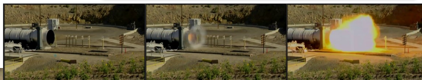
Essai d'un SRB de navette spatiale par ATK. Ci-dessous, phases de démarrage du « moteur » :
