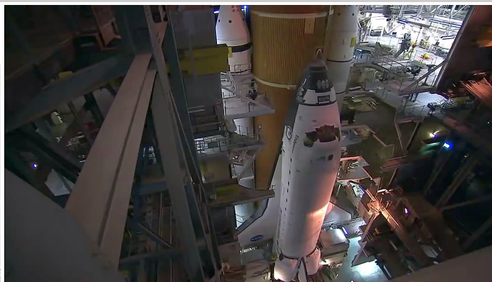
Endeavour est maintenant associée à la verticale au réservoir externe.
