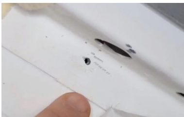
Photographie du trou dans le vaisseau Soyouz MC-09.
