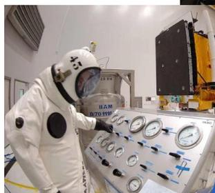
Test du système de propulsion et chargement du propulseur.
