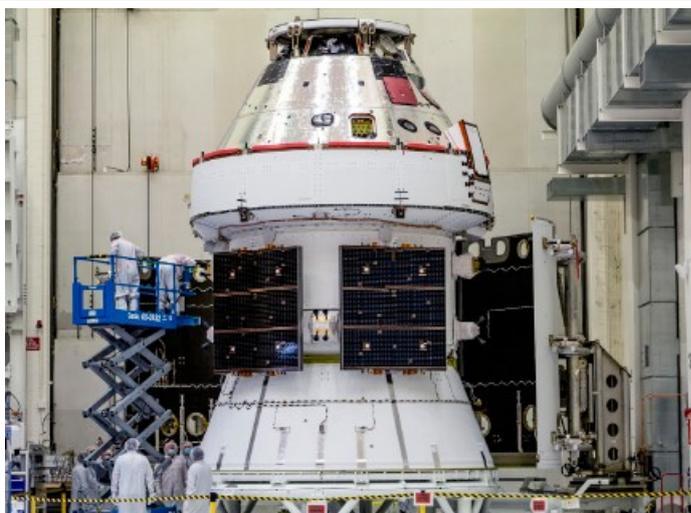
**Orion en cours d'intégration** : en haut, le module équipage (Lockeed Martin) et dessous, le module de service fourni par l'ESA, avec ses panneaux solaires, qui délivre l'énergie, la propulsion, l'air respirable, l'eau, et le contrôle thermique du module équipage. Le module de service est construit par Airbus. Six modules de service devraient être construits par l'Europe.
