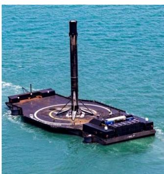
Un des drones de récupération du 1er étage (booster) de la fusée Falcon 9.
