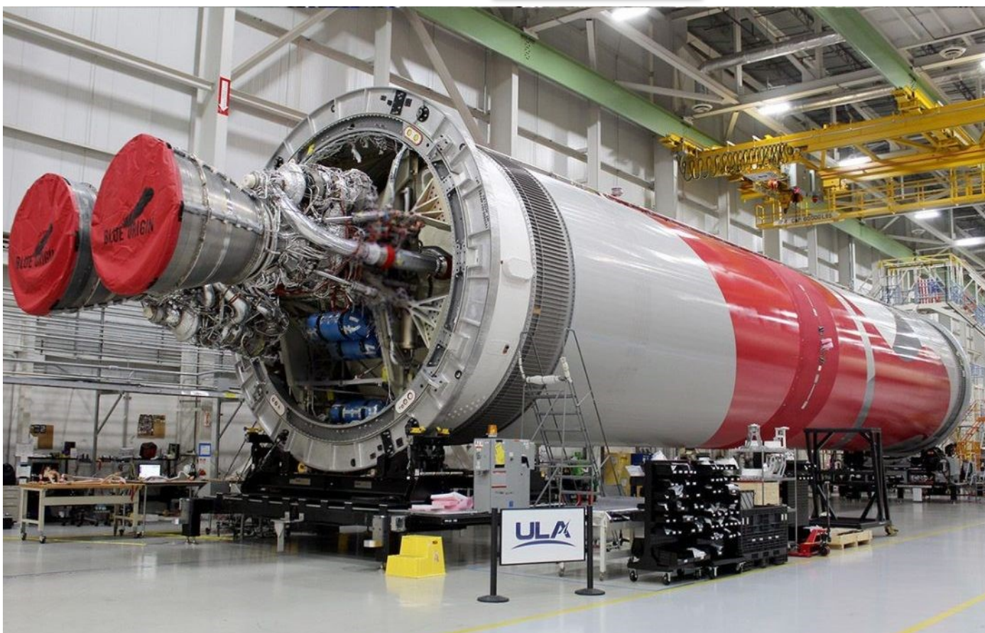
Les préparatifs de United Launch Alliance pour le Vulcan Flight 1 : 1 er étage central avec ses deux moteurs Blue Origin BE4.
