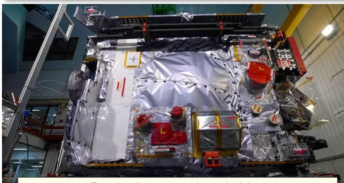
Façade « instrumentation » de Juice. La plupart de ses instruments sont sur un seul panneau.
