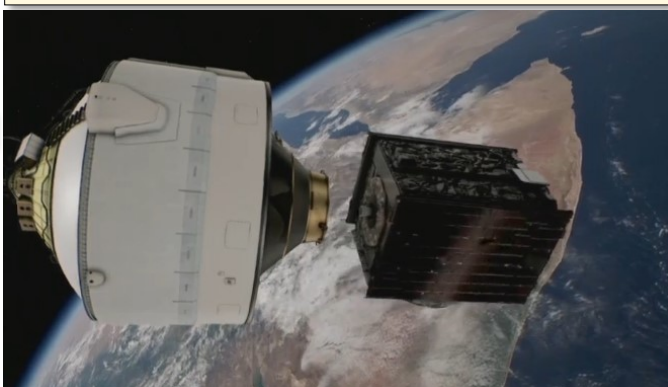
27 minutes après le lancement, c'est la séparation et la sonde s'échappe seule dans l'espace... Altitude : 1 517 km, distance parcourue : 10 677 km, vitesse : 9,83 km/s.
