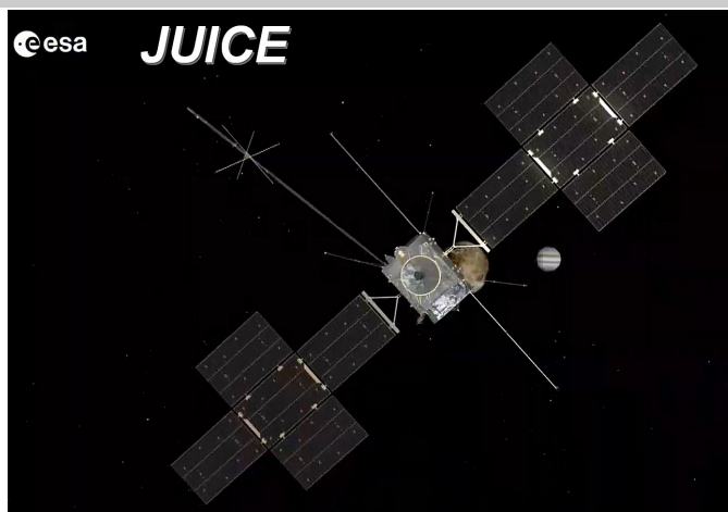
JUICE est équipée de gigantesques panneaux solaires dont la surface avoisine les 90 m 2 . De quoi satisfaire ses besoins en énergie à bonne distance du Soleil.
