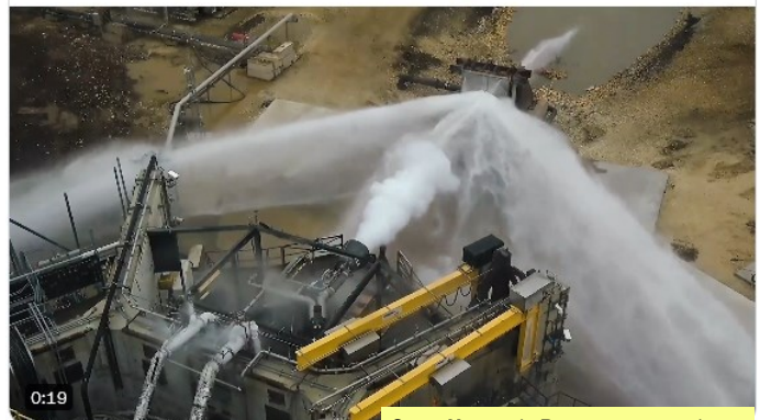
SpaceX : test du Raptor vers une plaque d'acier refroidie par eau.
