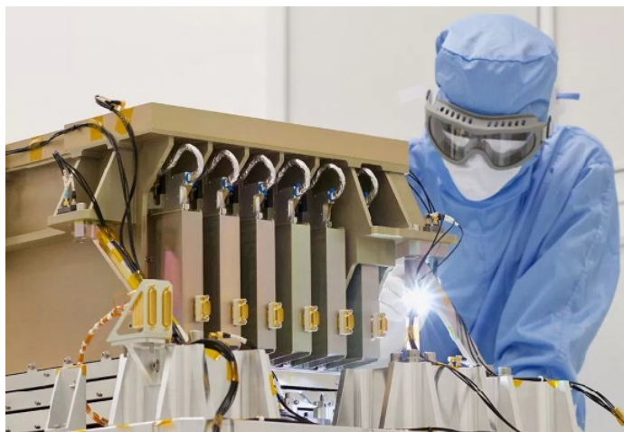
Le plan focal de VIS est composé d'une caméra carrée avec 36 capteurs CCD de 16 millions de pixels chacun. (image CEA)
