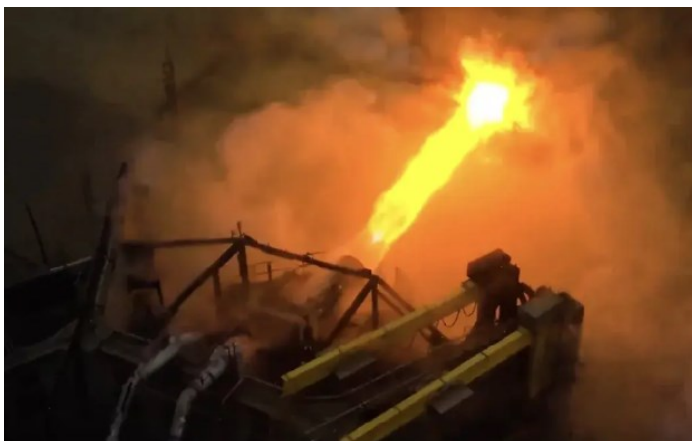
Mai 2023 : le moteur Raptor est testé ici en dirigeant l'éjection des gaz très chauds, un plasma ardent, vers une plaque métallique refroidie par de l'eau.
