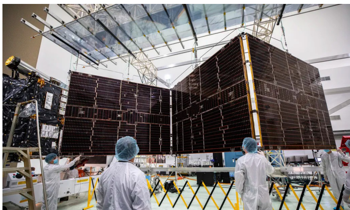
Pliage d'un des panneaux solaires du vaisseau spatial Psyche. (25 juillet 2023 - locaux Astrotech Space Operations, près du NASA Kennedy Space Center. (Image NASA/Kim Shiflett).
