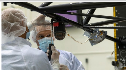
Les ingénieurs du Jet Propulsion Laboratory (Californie du Sud) intègrent l'instrument magnétomètre dans le vaisseau spatial Psyche le 28 juin 2021. (Image NASA/JPL-Caltech)
