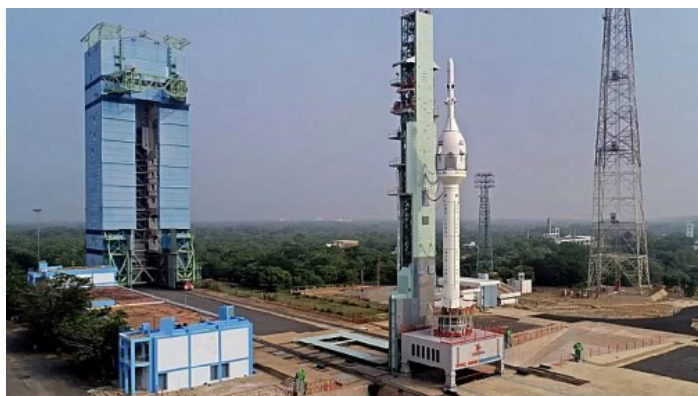
Le vaisseau spatial Gaganyaan (mission TV-D1) a été lancé à 4h30 UTC le 21 octobre 2023 depuis Sriharikota. Le test a été réalisé pour démontrer que l'équipage pouvait s'échapper en toute sécurité de la fusée en cas de dysfonctionnement de celle-ci. (Image ISRO)
