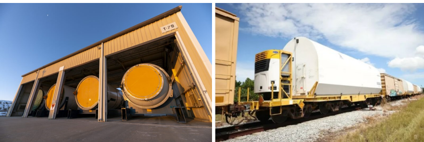
À gauche : quatre segments SRB (Solid Rocket Booster) sont stockés dans les installations de Northrop Grumman à Promontory, dans l'Utah (Image : Northrop Grumman). À droite : train transportant les dix segments Solid Rocket Booster (encapsulés dans les conteneurs d'expédition blancs) pour la mission Artemis 2 arrive au Kennedy Space Center (Image NASA/Frank Michaux).
