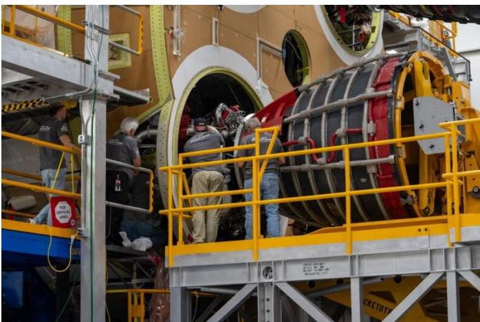
Les techniciens installent un moteur RS-25 de l'étage central. (Image NASA/Stephen Seipel)
