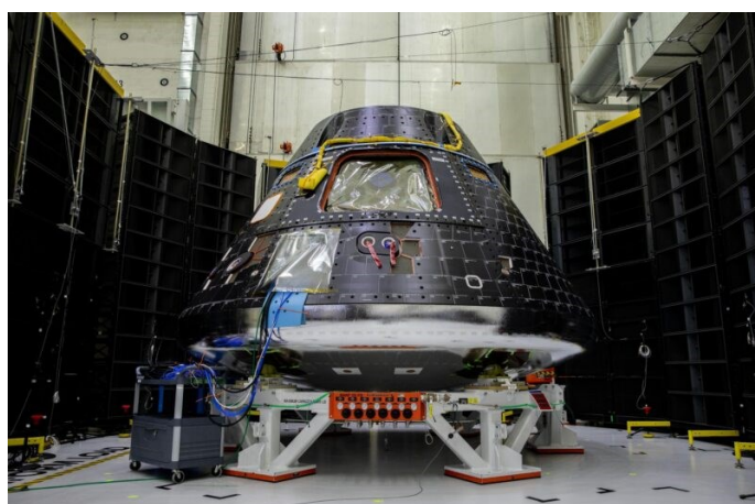
Le module d'équipage Orion pour Artemis 2 terminé est entouré de haut-parleurs à l'intérieur du bâtiment des opérations et des tests de la NASA pour vérifier sa résistance aux vibrations et ondes sonores puissantes. (Image NASA/Kim Shifflett)
