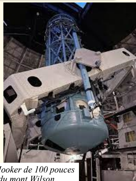
Le télescope de 100 pouces avec sa poutre munie de 4 miroirs avec les 2 miroirs les plus externes mobiles.
