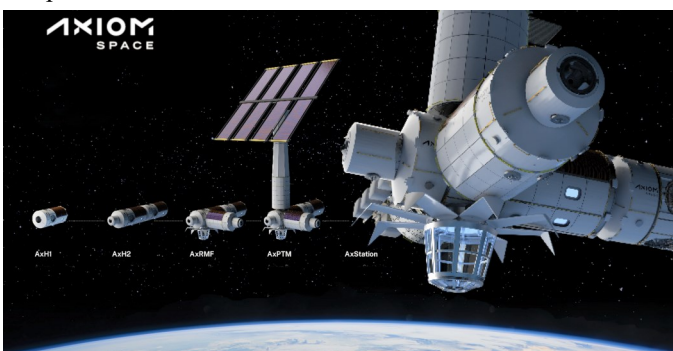
Les différentes phases de construction de la station spatiale Axiom (Image Axiom).
