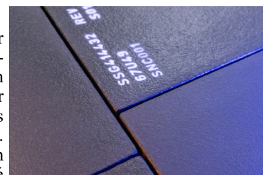
Vue rapprochée des tuiles de protection thermique du Dream Chaser. (image : Sierra space)
