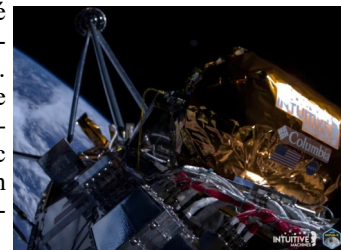
Vues de plusieurs caractéristiques clés de l'atterrisseur IM-1 Ulysse, notamment le câblage, une jambe d'atterrissage et un réservoir d'hélium enveloppé dans l'isolation de Columbia Sportswear, sont capturées par une caméra d'ingénierie. (Image : INTUITIVE Machines)
