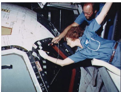
Les techniciens de Rockwell, réparent les tuiles du système de protection thermique (TPS) sur le bord de l'une des fenêtres de Columbia avant le lancement de la mission STS-4.
